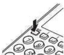
電源ボタンを押し、電源をONにします。パスワードが設定されている場合、業務パスワードを入力します。
